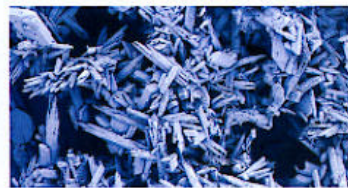
Links – Kalkstruktur mit Aquavital: feinkristallines Erscheinungsbild, das Bindungs- und Ablagerungsverhalten von Kalk deutlich entschärft. Rechts ohne Aquavital: grobkristallines Erscheinungsbild verursacht Kalksteinablagerungen
